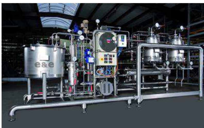
Figure 23 : Unité pilote d'extraction (Source http://www.eunde-verfahrenstechnik.de/france/pilot-plants.html )
