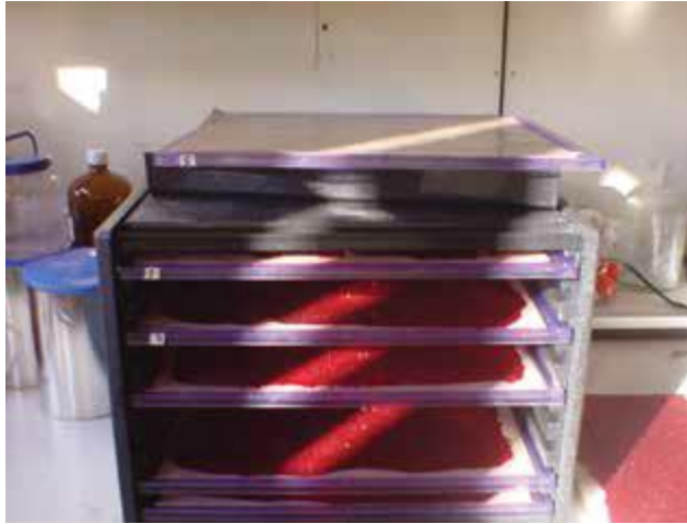
PHOTO n°14 : Séchoir électrique pour fabrication des feuilles déshydratées
