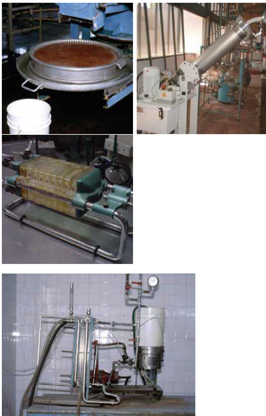
PHOTO n°11 : Echangeur de chaleur
