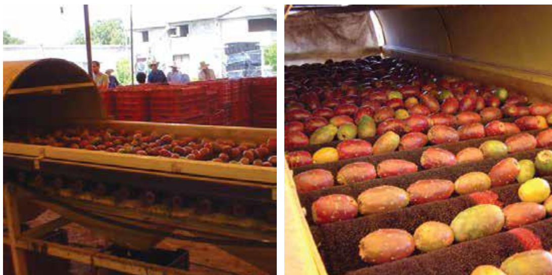
PHOTO n°7 Machines de brossage des épines de figue de Barbarie
