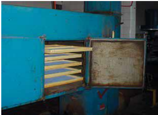
PHOTO n°15 tunnel de séchage à air forcé
